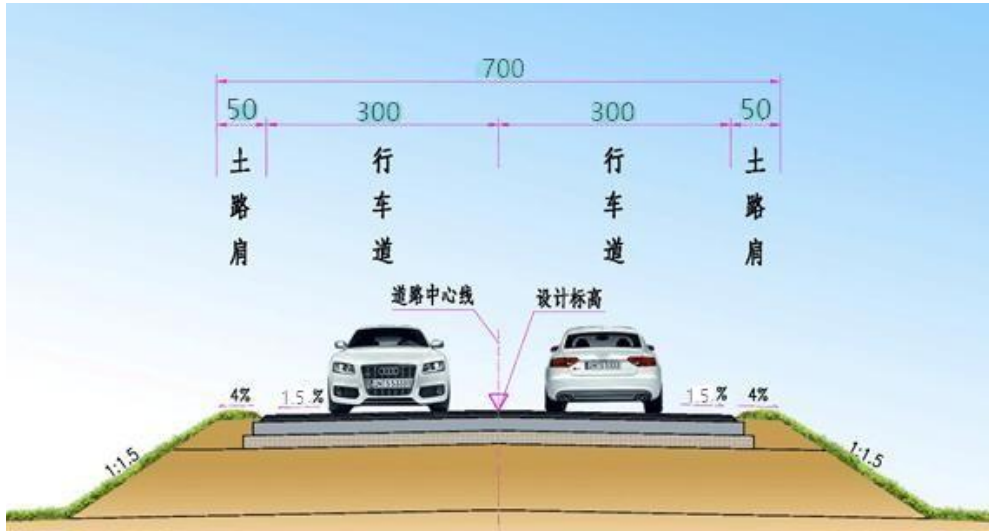
图 6-1 路基标准横断面图(一般路段)
