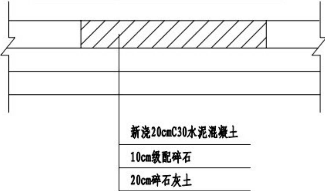
I-I 断面路面挖除后新铺结构层
