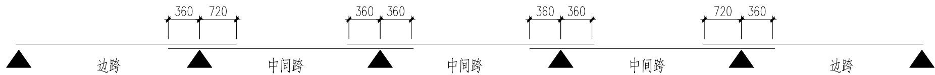
连续檩条搭接示意图
