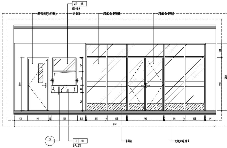
1 SECTION 二层输液室(原妇查室)走廊立面图
