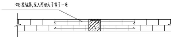
注: 砌砖完成后, 水泥砂浆内外抹灰(20厚1:2.5的水泥砂浆), 砌墙墙体长度 $\geq 5$ 米需加构造柱, 高度 $\geq 4$ 米需在墙体中间加圈梁
