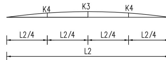
1-1平缘石背面圆弧放样图
