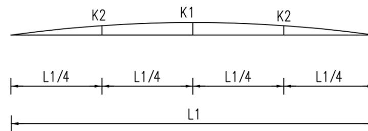
1-1平缘石侧面圆弧放样图
