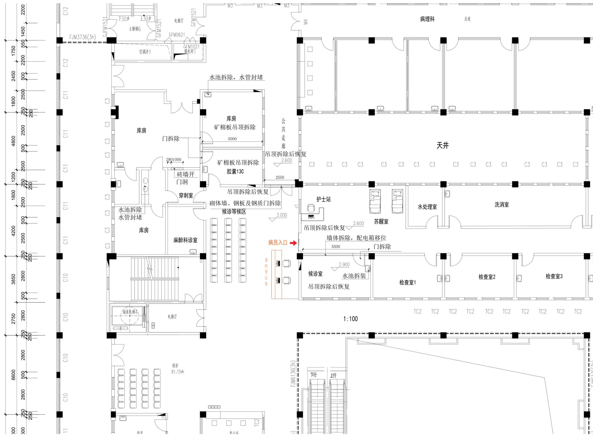
备注: 原候诊区拆除两边区域吊顶拆除。
