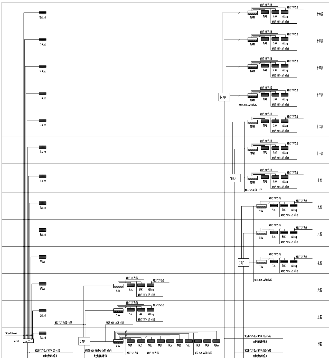
配电系统图干线图
