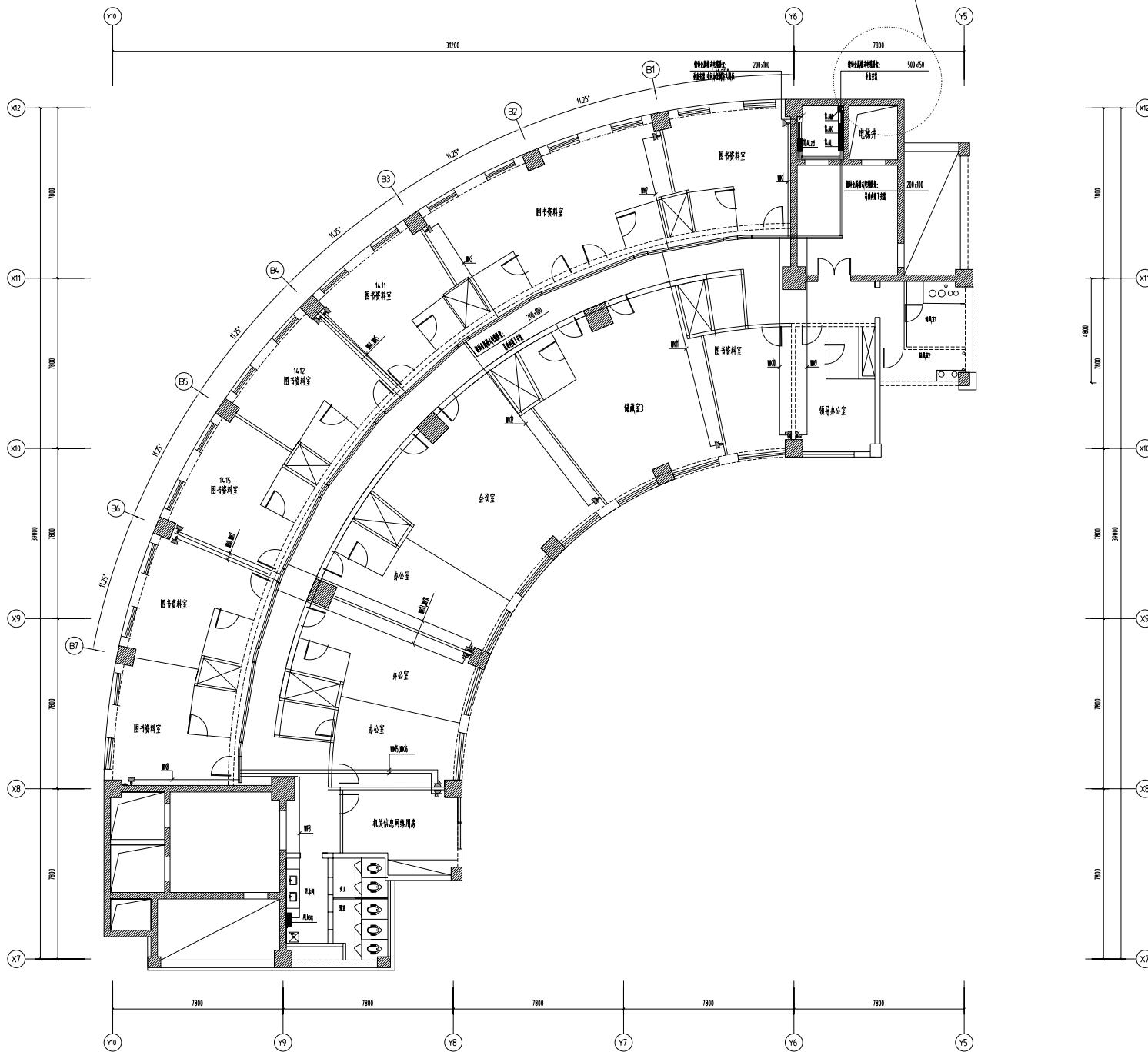
十四层配电干线及空调插座平面图1:200
