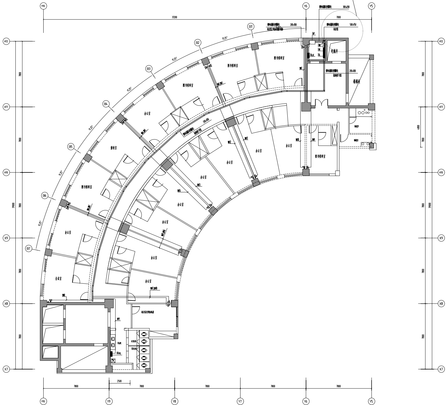
七层配电干线及空调插座平面图1:200
