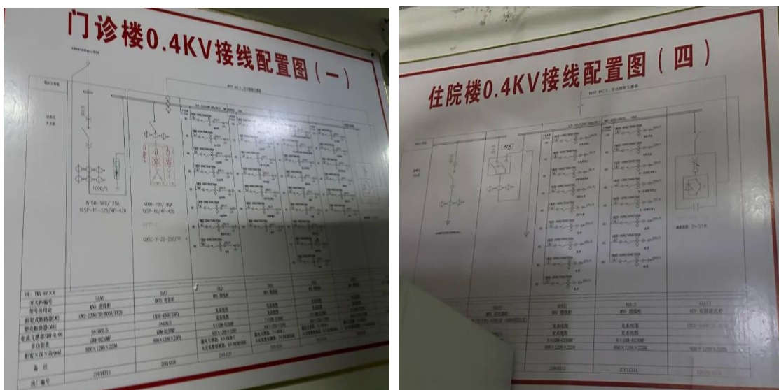
图 2.2.1-5 门诊楼、住院楼低压侧接线图
