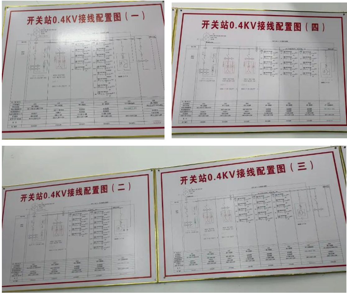
图 2.2.1-6 开关站低压侧接线图
