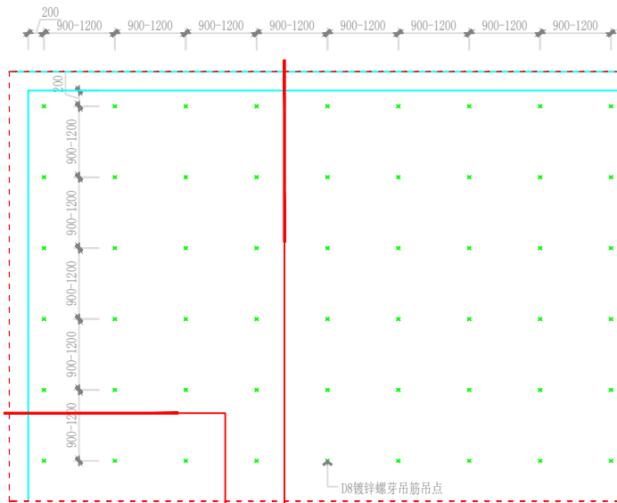
DETAIL 轻钢龙骨吊顶标准大样图 SCALE 1:50
