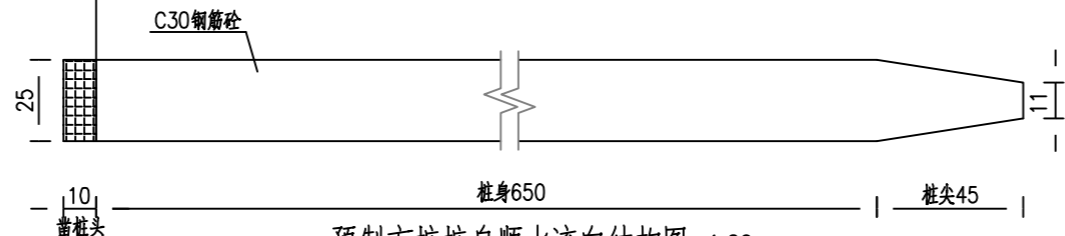
预制方桩桩身顺水流向结构图 1:20
