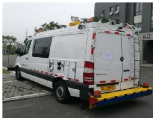
图2-10 路面破损调查用滚尺及全自动车载落锤式弯沉仪
