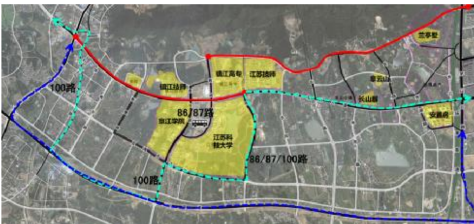
图5-16 高校园区段施工绕行示意图
