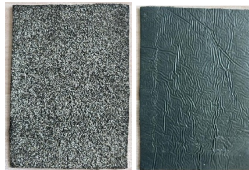
(1) “高聚物复合结构高粘膜” 的防裂性能满足《沥青加铺层用聚合物改性沥青抗力贴
