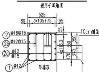
防撞护栏侧石构造钢筋图 1:30
