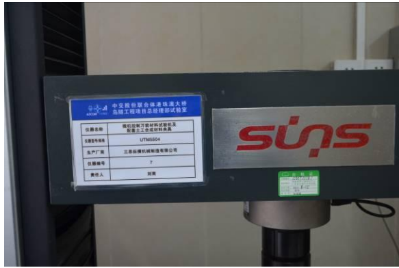
图 12 仪器设备粘贴管理标识和状态标识
