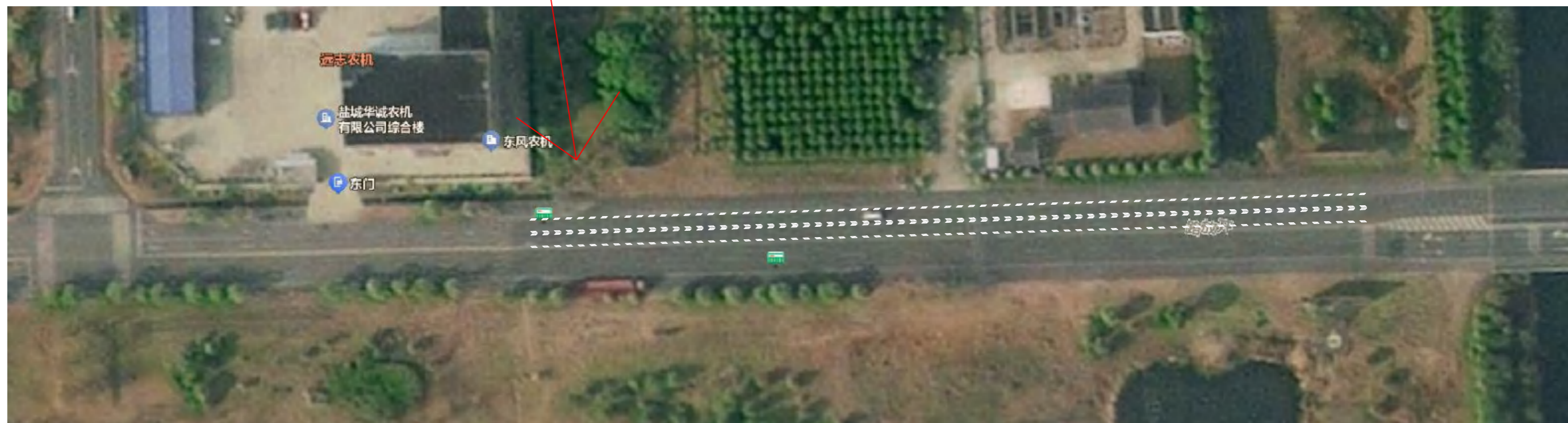
楼丁线往南至北环路下坡段，施划约200m车道减速标线，面积约120平
