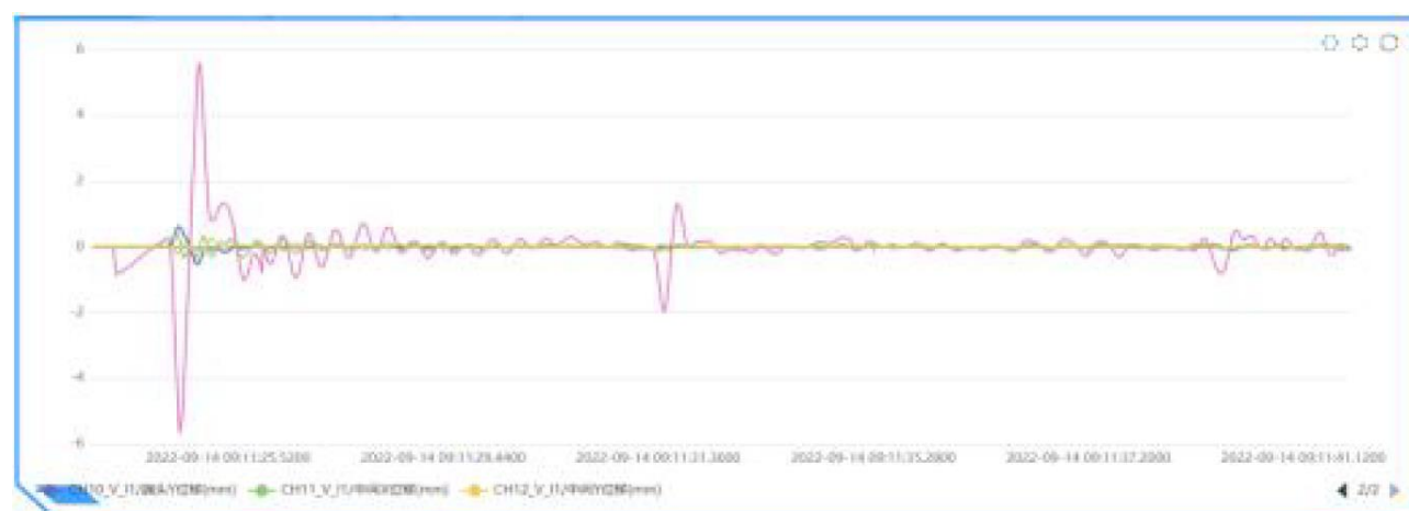
c.靠船墩动态监测系统（位移实时曲线图）
