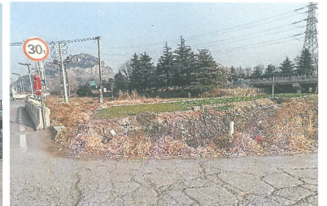
桥梁端头缺少护栏防护
