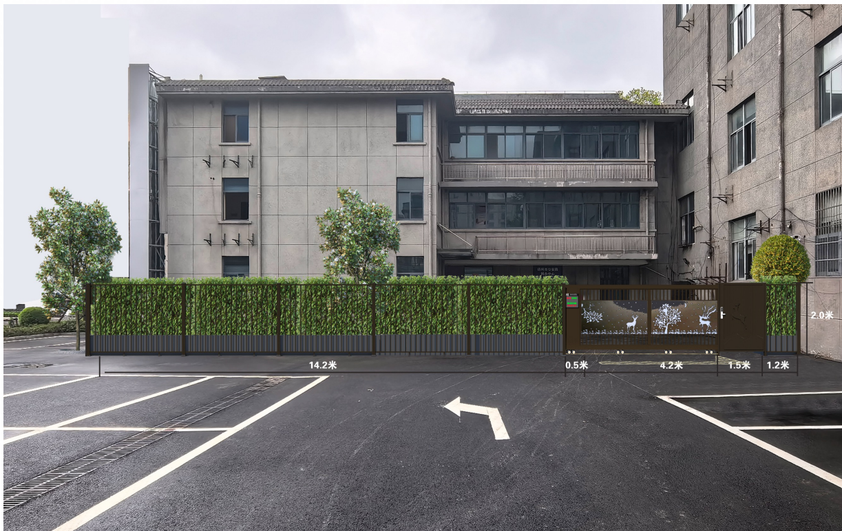
围栏、移门统一高度2.0米，轨道移门长4.2米，人行推门宽1.5米。花箱高0.5米，内种植北海道黄杨。2棵广玉兰高4米，1棵桂花树高3米。
