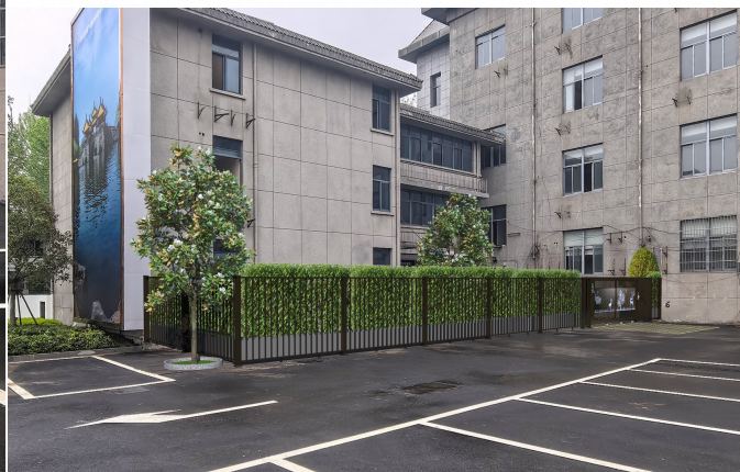
围栏、移门统一高度2.0米，轨道移门长4.2米，人行推门宽1.5米。花箱高0.5米，内种植北海道黄杨。2棵广玉兰高4米，1棵桂花树高3米。
