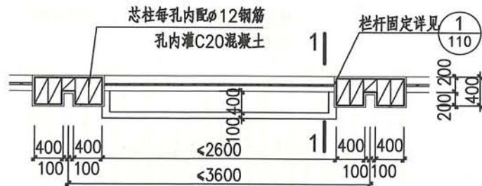
混凝土砌块围墙平面
