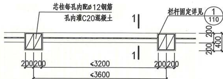
混凝土砌块围墙平面
