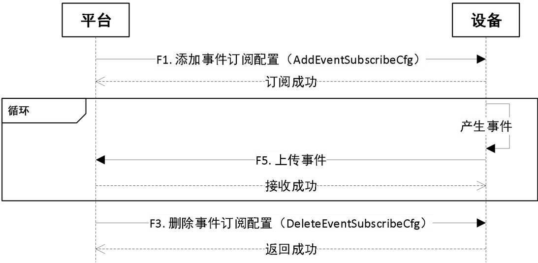
图 3.3-2 事件订阅和上报流程
