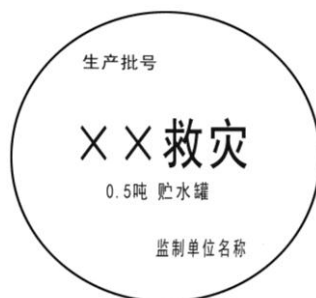
图3 软体贮水罐盖标志
