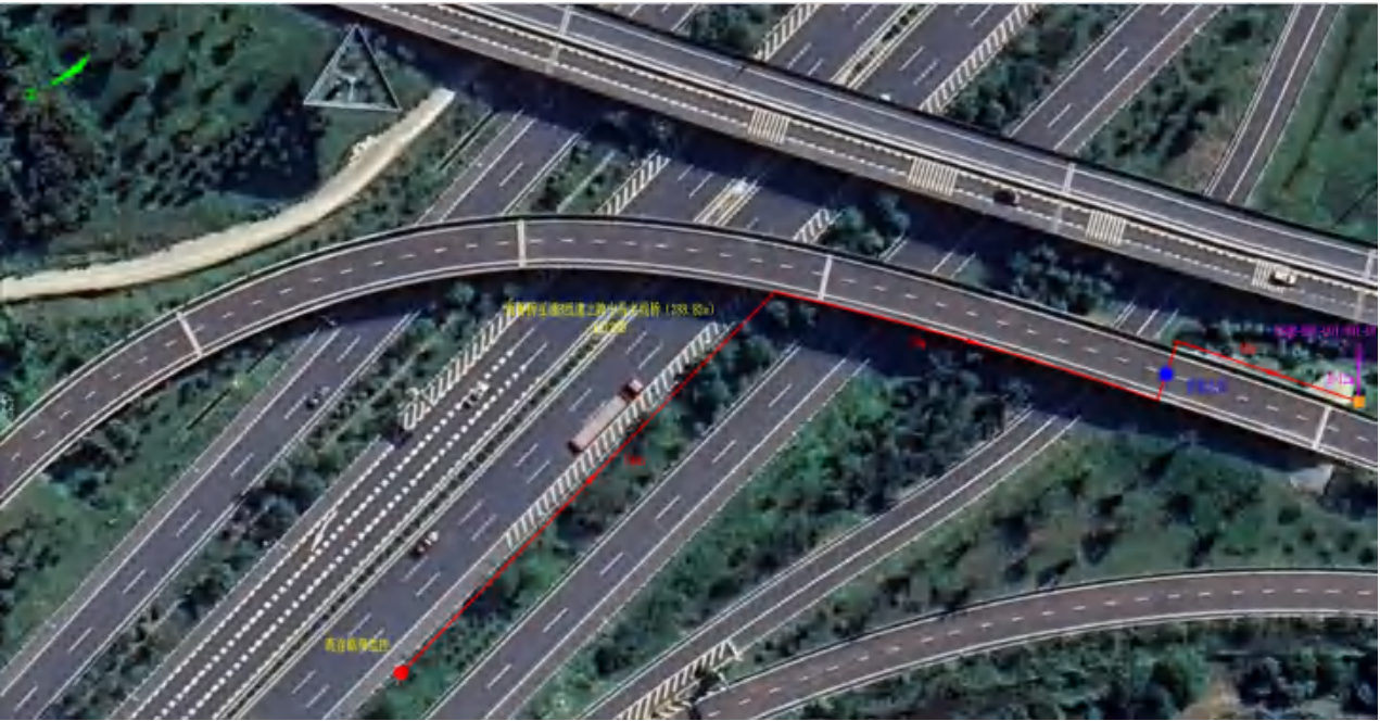
(b) 平面布置图 图 5.3-3 西善桥互通 B 匝道桥上跨宁马主线桥视频监控测点示意图（单位：cm） 视频监控采用高清摄像机，对应技术参数参照 5.2 节。
