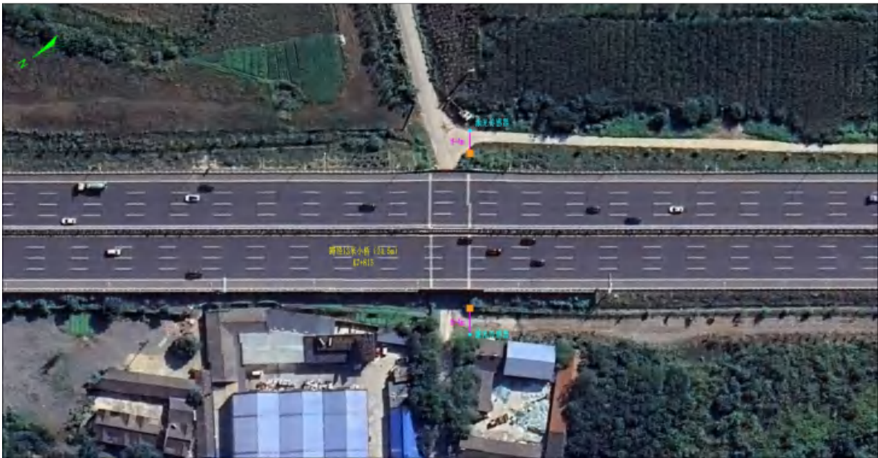
图 5.5-5 跨径 13 米小桥超高车预警系统测点示意图（单位：cm）
