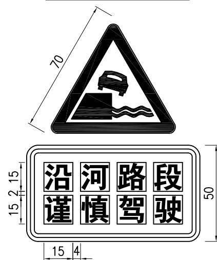
临水路段警告标志
