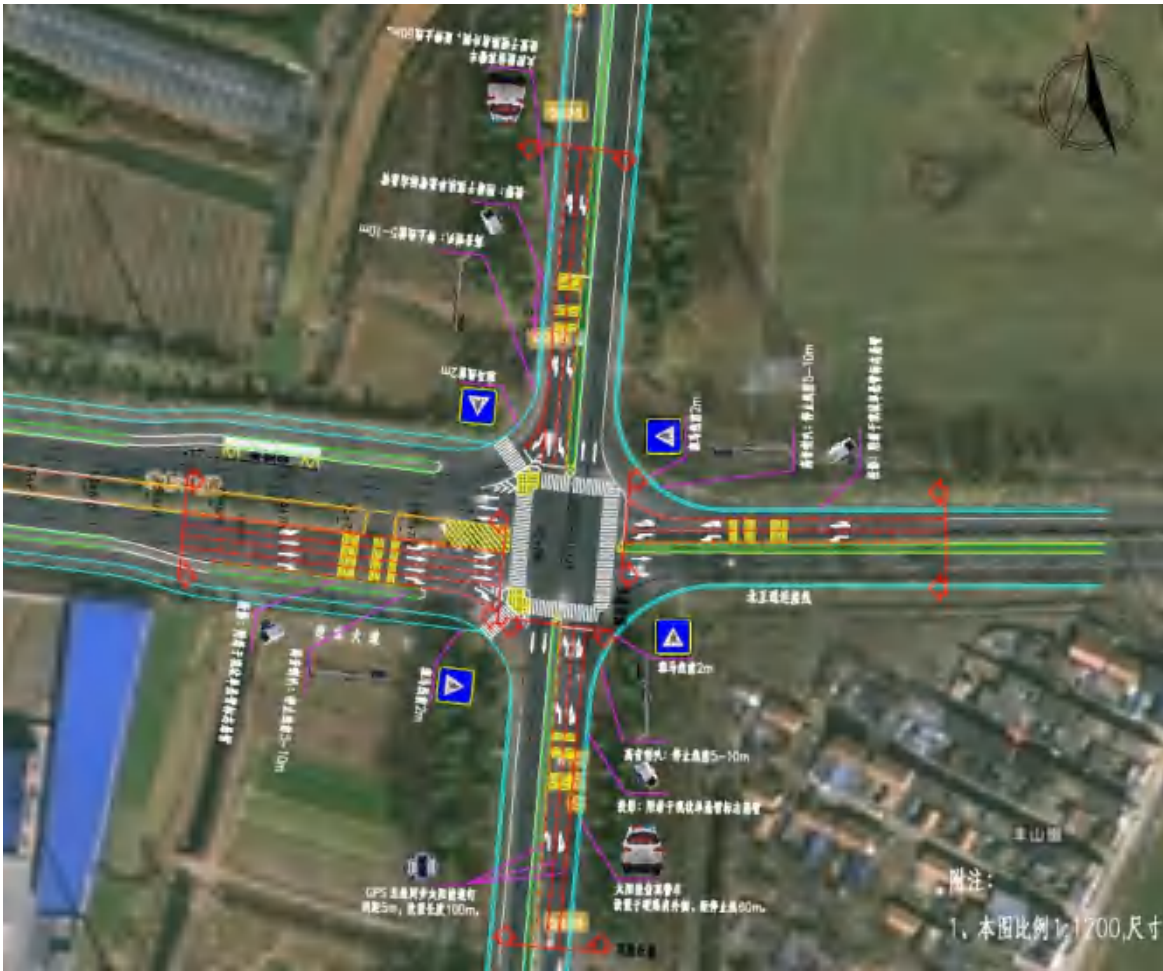
交叉口整改措施
