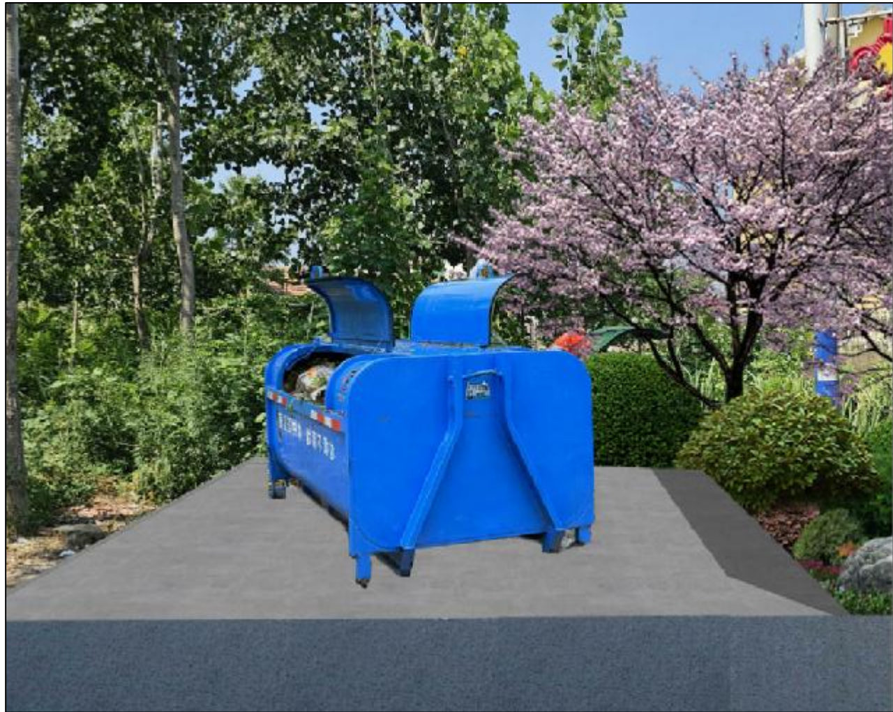
③ 环卫转运垃圾箱地面硬化地面 意向图，尺寸为3米X5米X0.2厚
