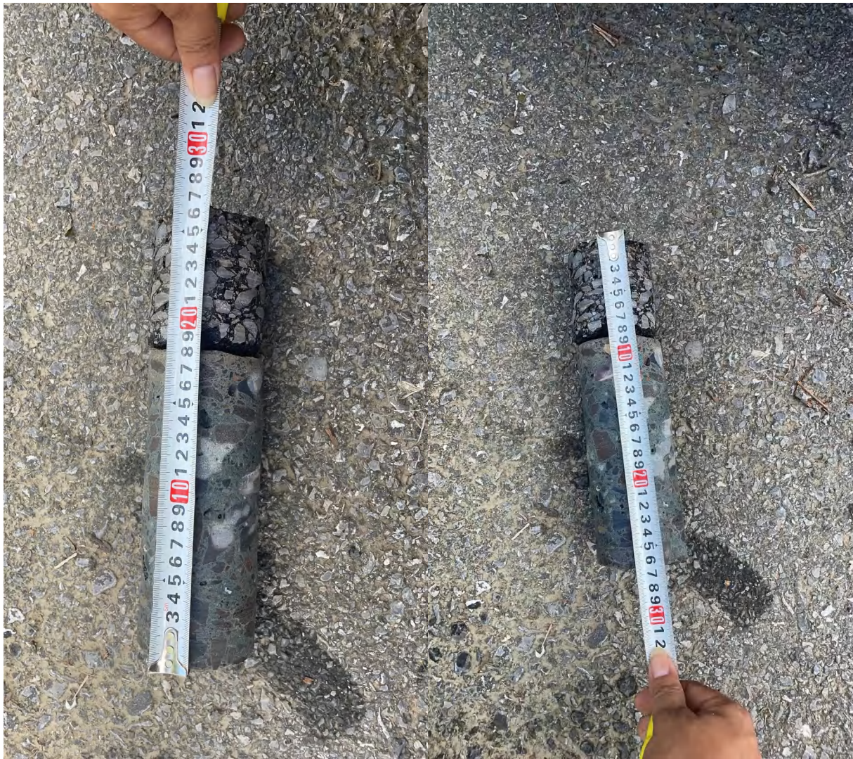
光丁线（取芯完整，基层混凝土厚度约 18cm，面层沥青约 8cm）
