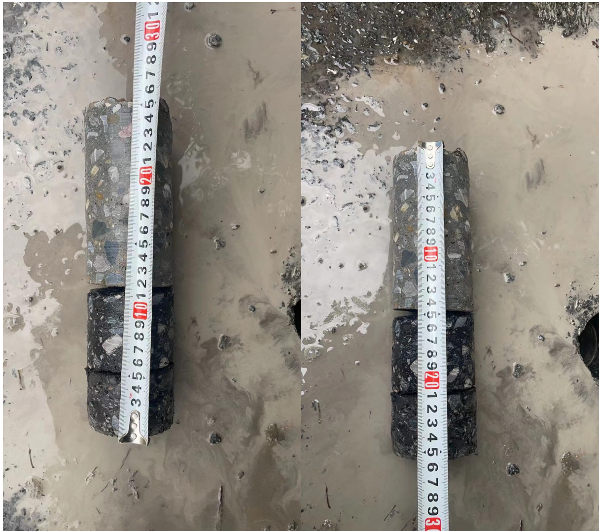
北杨线 2（取芯完整，基层混凝土厚度约 15cm，面层沥青约 4cm+6cm）
