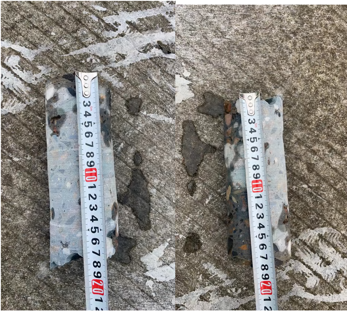
井曹线（取芯完整，混凝土厚度约 18cm）
