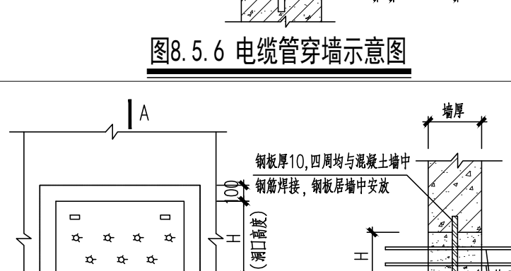
图8.5.7 群管穿墙示意图
