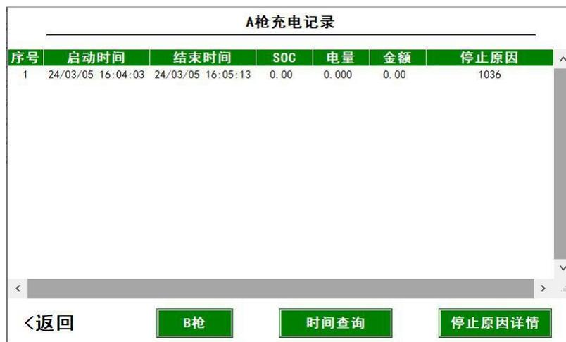
图 6-14 展示了“A枪充电记录”的查询界面。界面顶部显示标题“A枪充电记录”。下方是一个表格，表格的表头包含“序号”、“启动时间”、“结束时间”、“SOC”、“电量”、“金额”和“停止原因”。表格中显示了一条记录，序号为 1，启动时间为 24/03/05 16:04:03，结束时间为 24/03/05 16:05:13，SOC 为 0.00，电量为 0.000，金额为 0.00，停止原因为 1036。界面底部有四个绿色按钮，分别是“<返回”、“B枪”、“时间查询”和“停止原因详情”。
