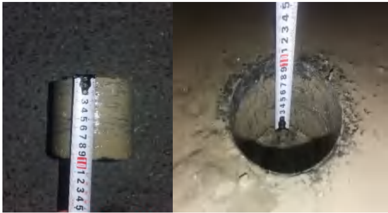
文峰北路（最下面的取不出来，基层深度>20cm，面层 9cm）
