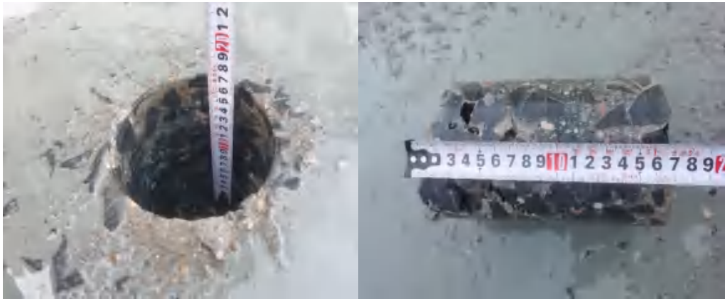
陈吕路（取芯完整，水泥板厚度约为 17cm,现场大量破碎板块）
