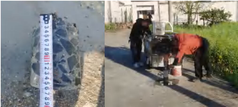
城东路水泥混凝土段（取芯完整，水泥板厚度约为 16cm）
