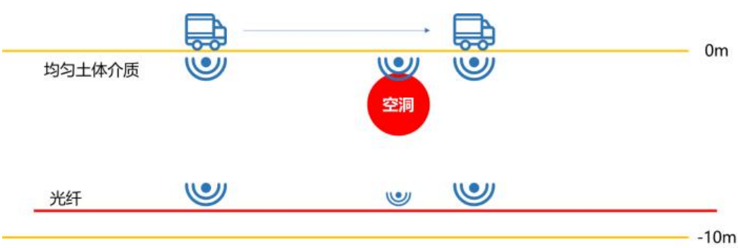
图 4-34 地下空洞导致振动能量衰减
