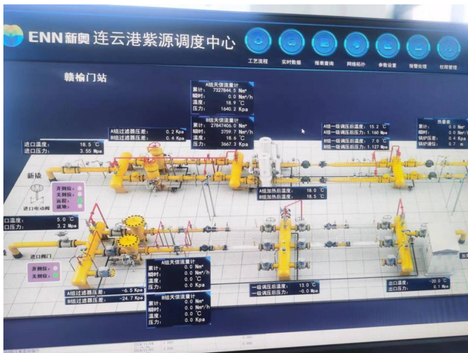
图 3-4 燃气信息化平台 SCADA 系统
