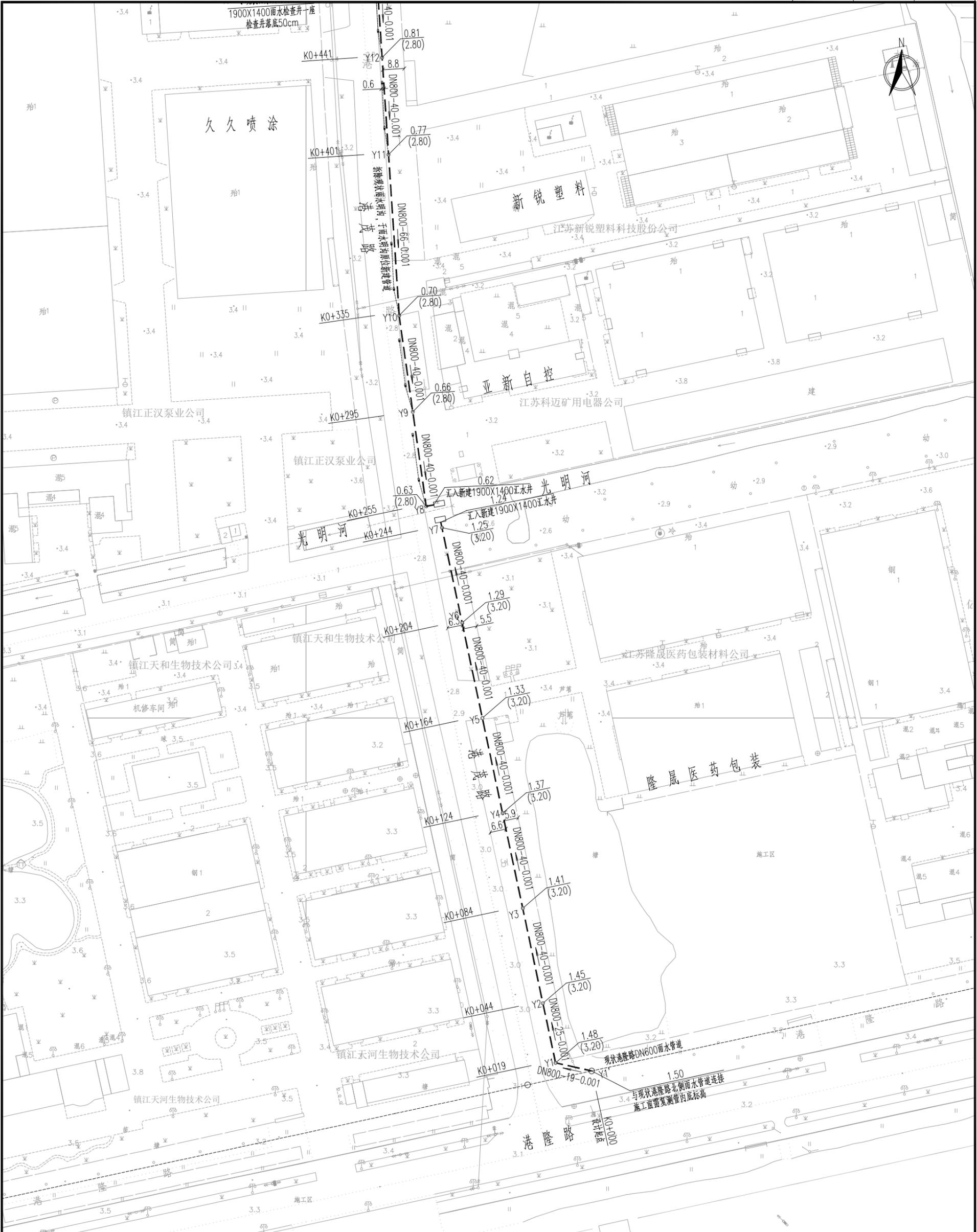
雨水管道平面图(二)
