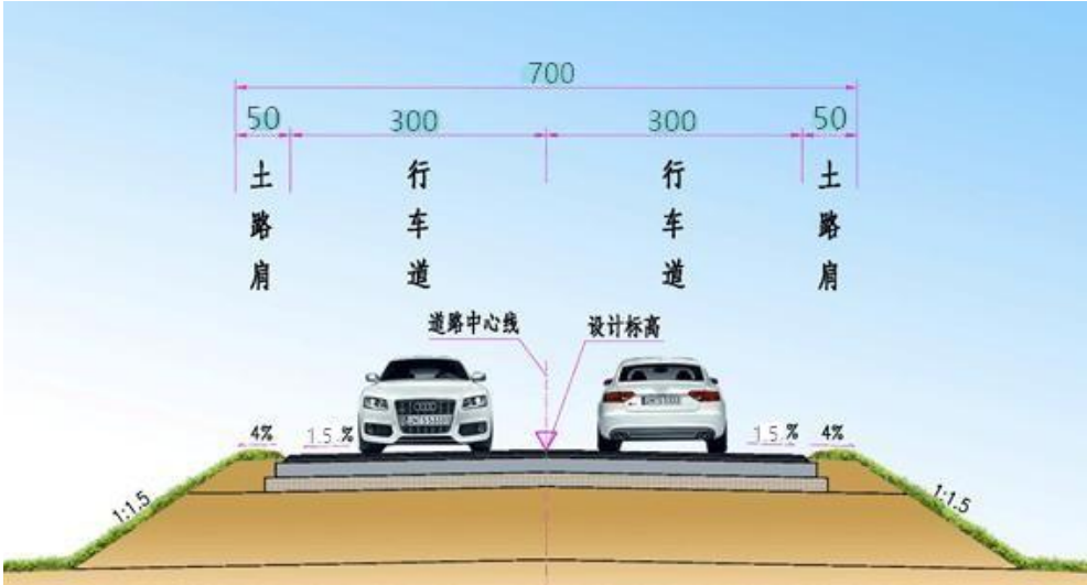
图 6-1 路基标准横断面图(一般路段)
