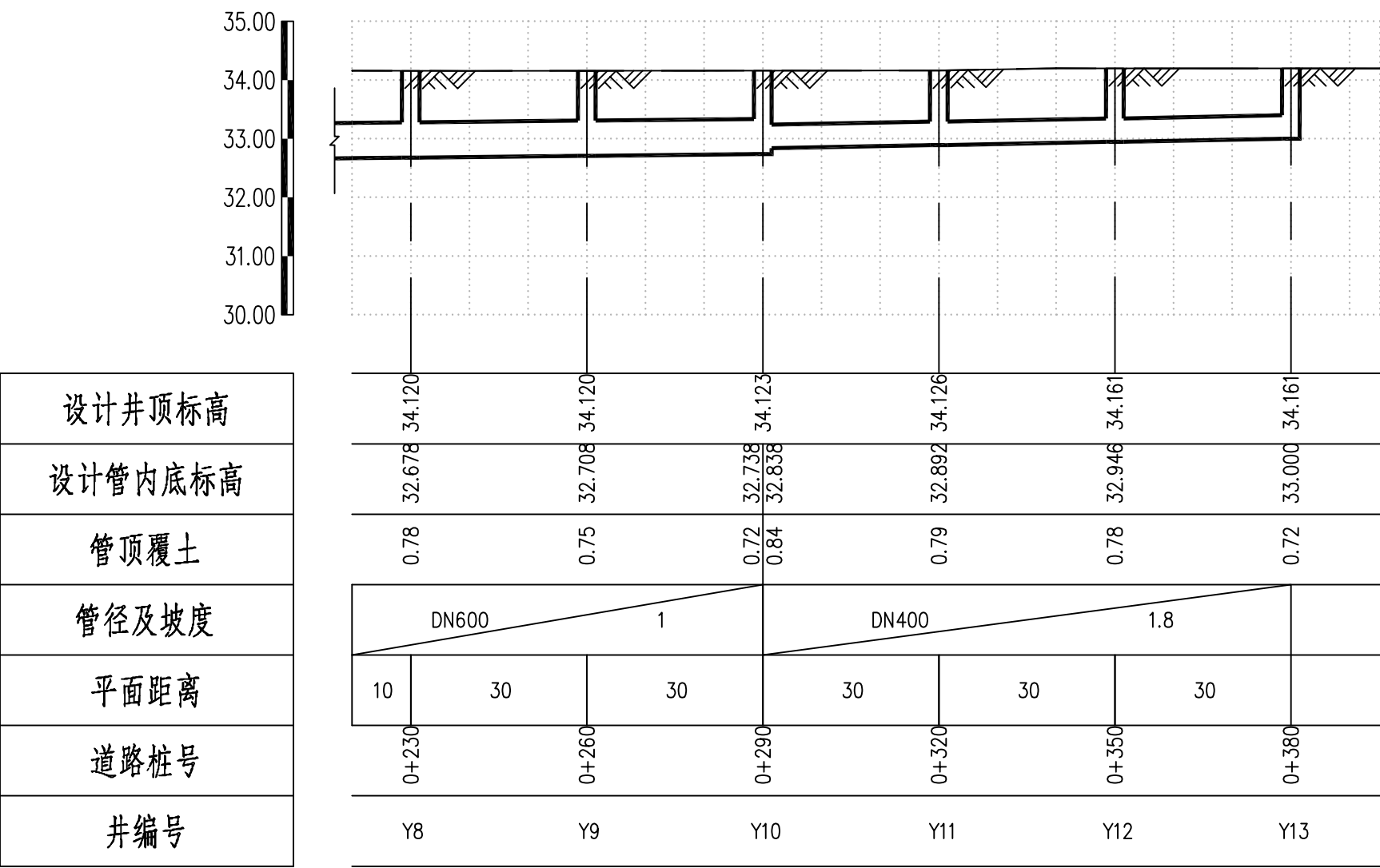
雨水管道纵断面图 竖 1:100 横 1:1000
