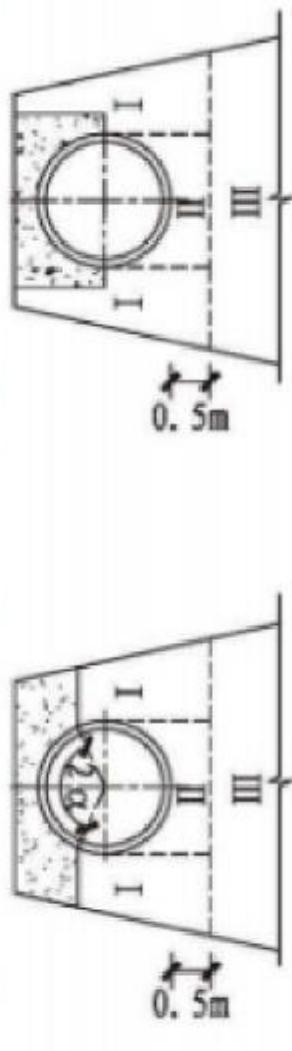
图1 混凝土基础沟槽回填
