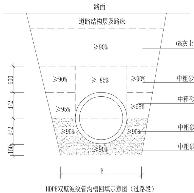
说明：管道铺设道路开挖，原状路面建设标准高时，按照原状路面恢复。
