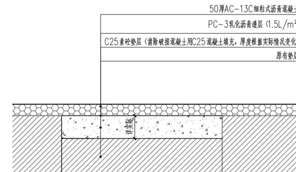
混凝土破损修复做法 1:10
