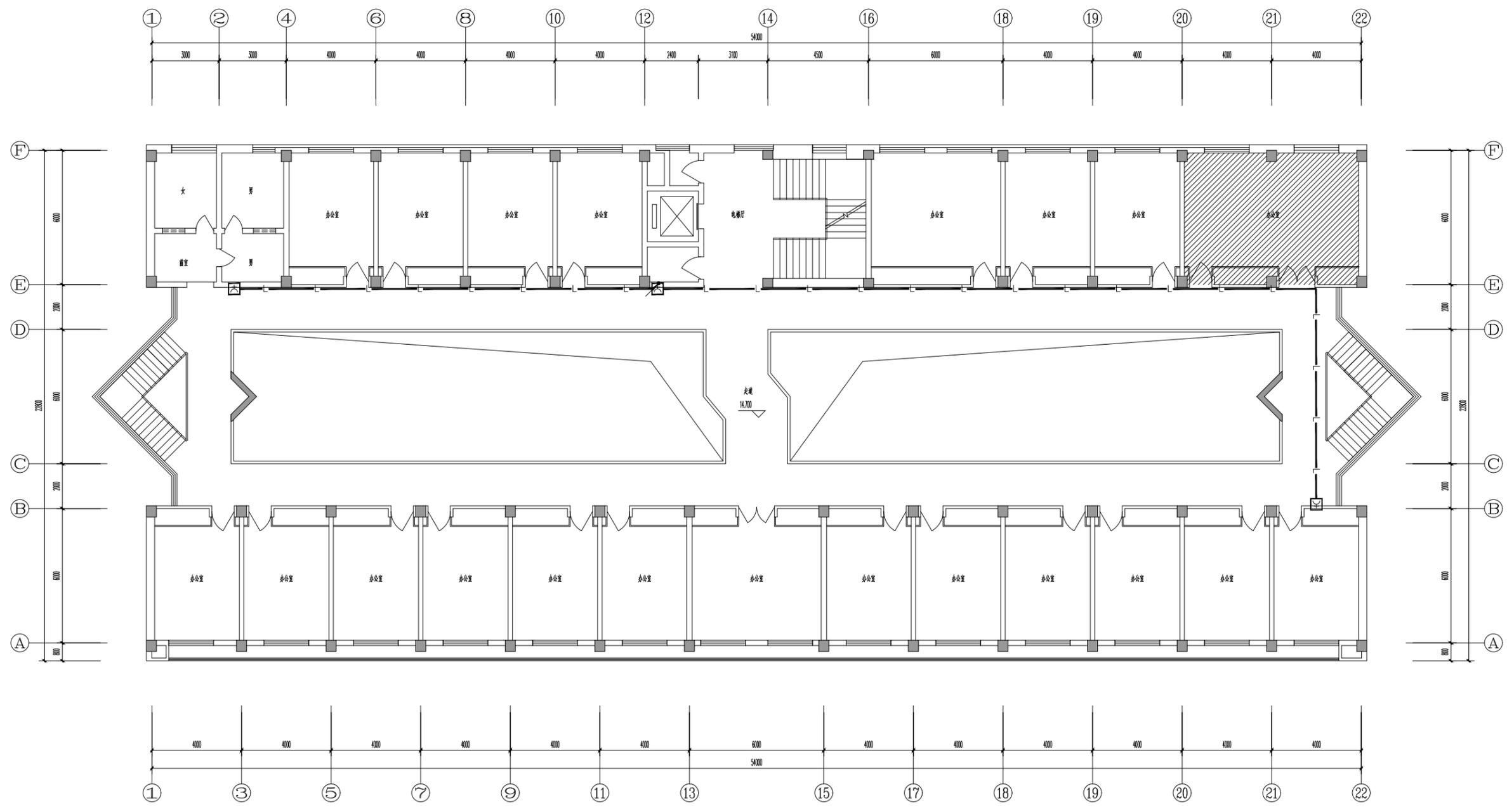
五层消火栓联动平面图 1:100
