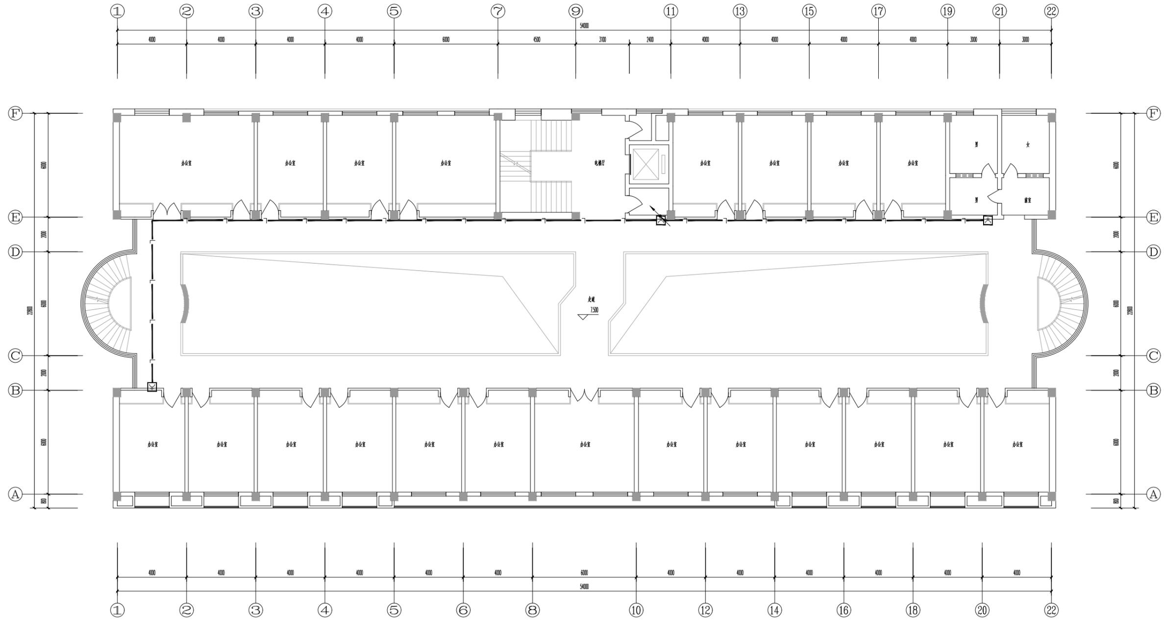
三层消火栓联动平面图 1:100
