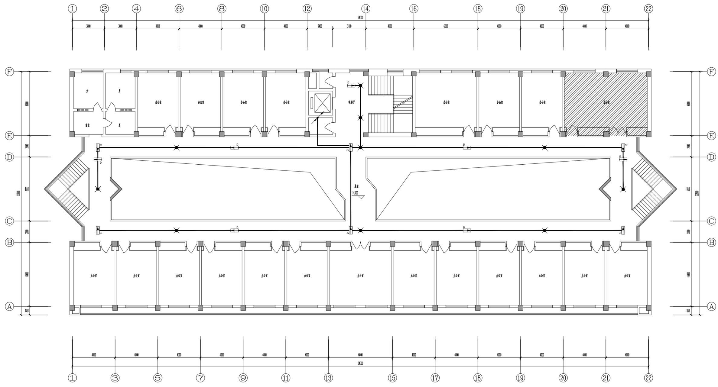
五层应急照明平面图 1:100
