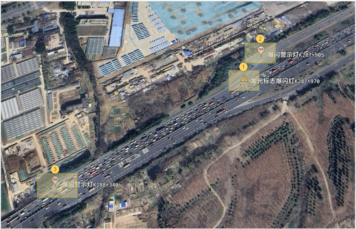
图 3.25 主线合流段爆闪预警装置布设图
