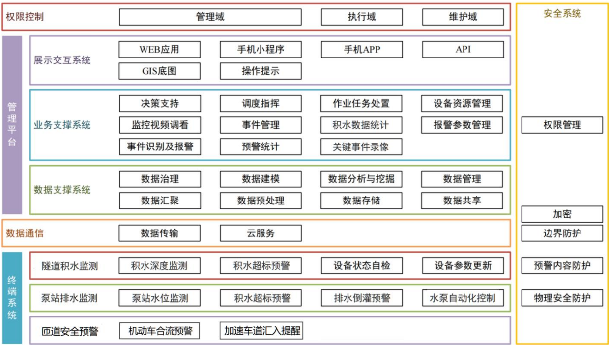
图 3.2 系统应用功能架构图
