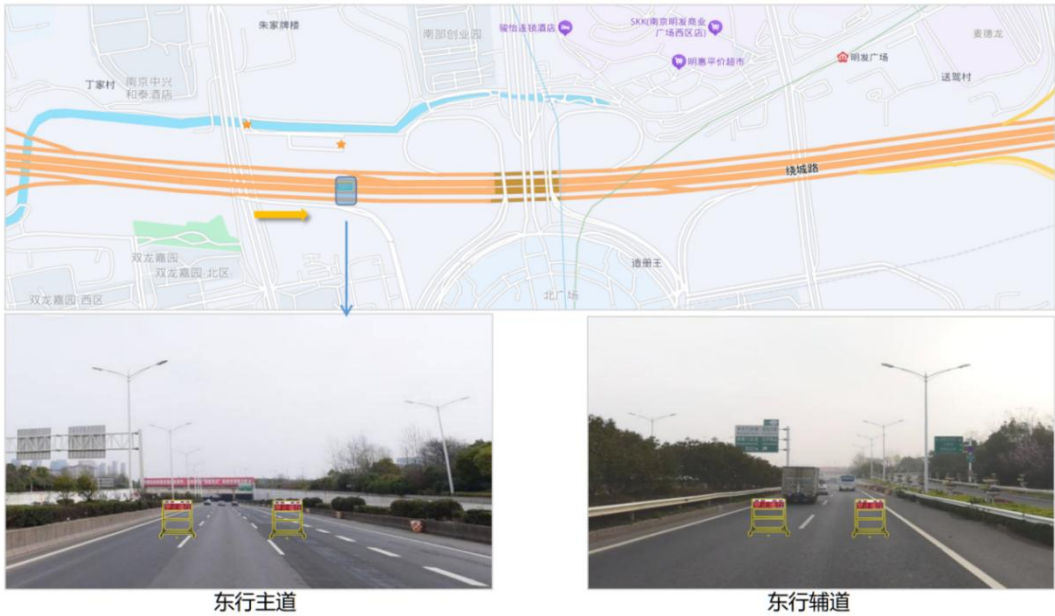
图 3.22 移动式交通诱导设备布设示意图（东行方向）
