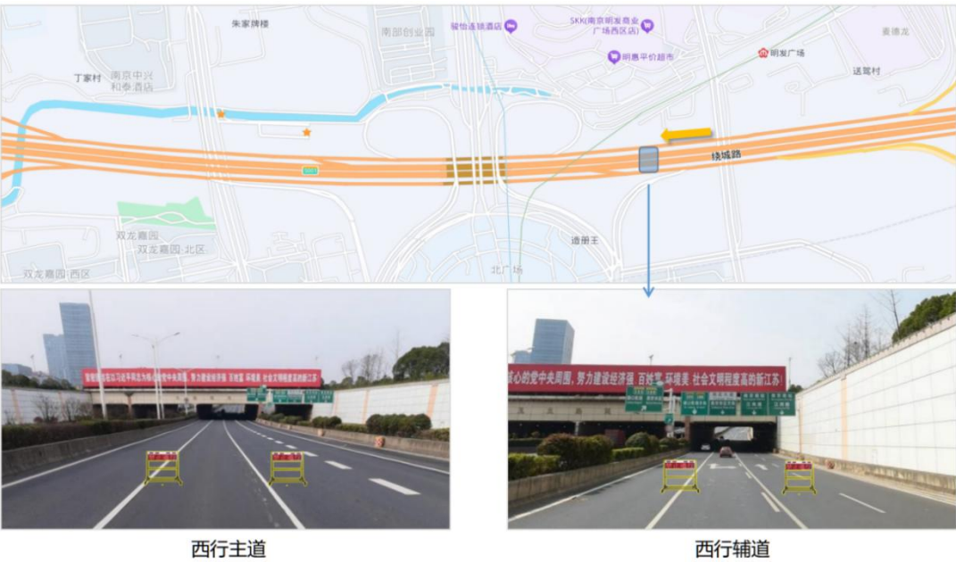
图 3.23 移动式交通诱导设备布设示意图（西行方向）
