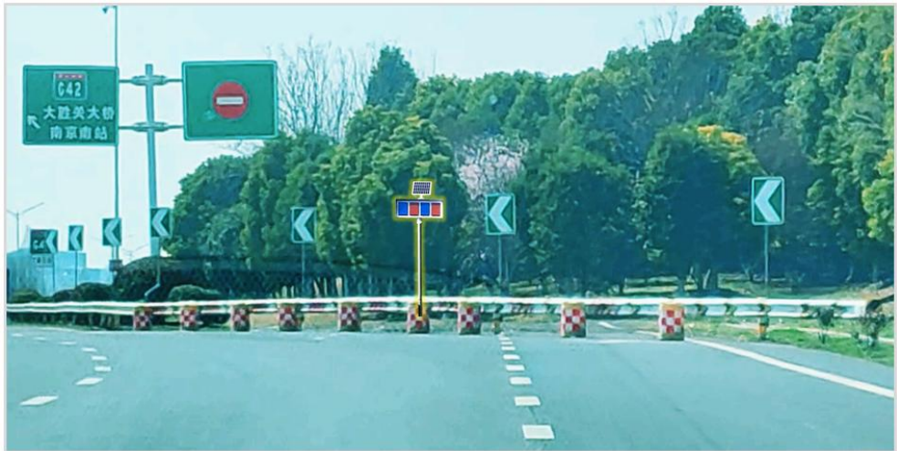
图 3.27 匝道辅道向左并入主线末端爆闪提醒 (K287+905)
