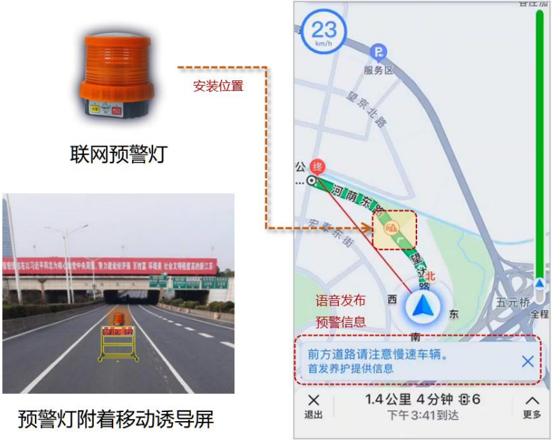
图 3.24 导航联网智慧锥桶预警灯布设示意图
