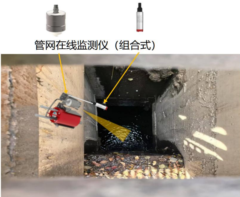
图 3.15 隧道跌水点水位监测装置示意图
