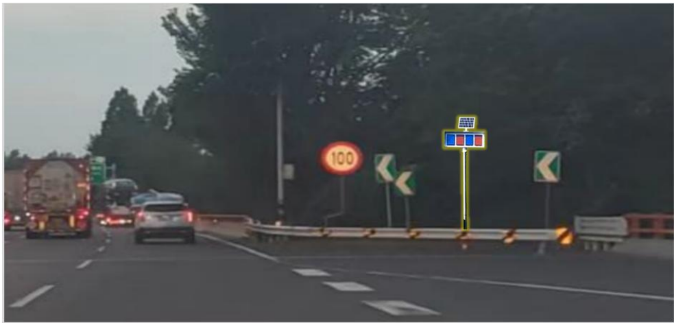
图 3.28 加速车道向左并入主线末端爆闪提醒 (K288+340)
