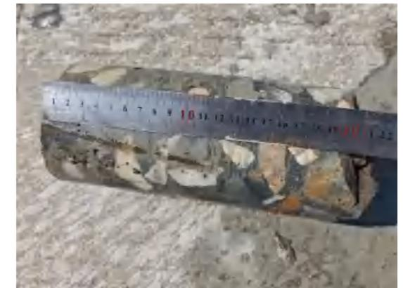
K0+510 (西侧) 处道路无病害处芯样，原老路水泥面层成型较好，芯样平均总厚度 20.2cm。
