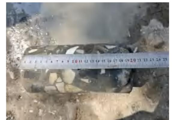
K0+600 (西侧) 处道路无病害处芯样，原老路水泥面层成型较好，芯样平均总厚度 19.6cm。
