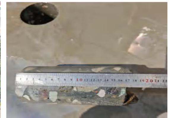
K0+224 (西侧) 处道路无病害处芯样，原老路水泥面层成型较好，芯样平均总厚度 16.7cm。
