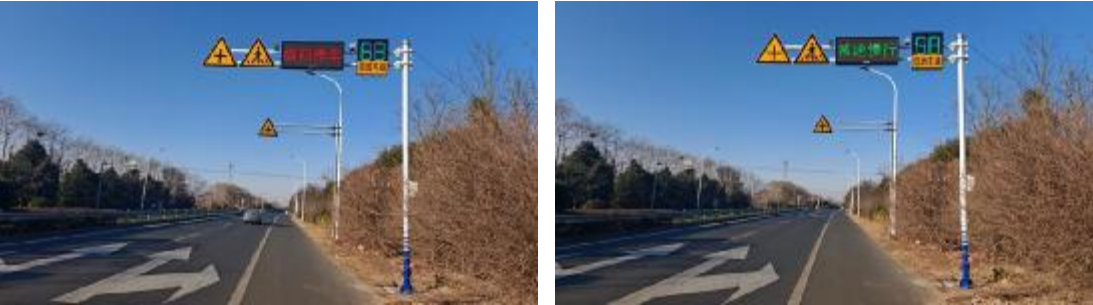
行人过街预警系统主路效果图（左：常规状态，右：预警状态） C 其他警示设施
