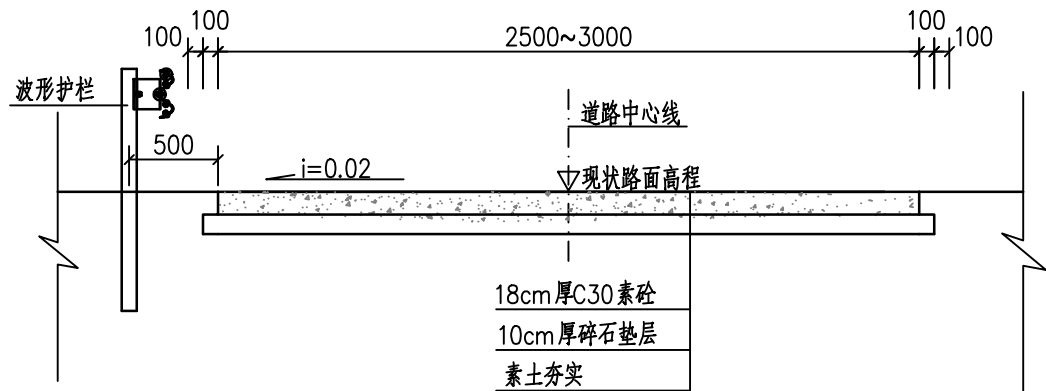
新建砼道路结构断面图 1:50
