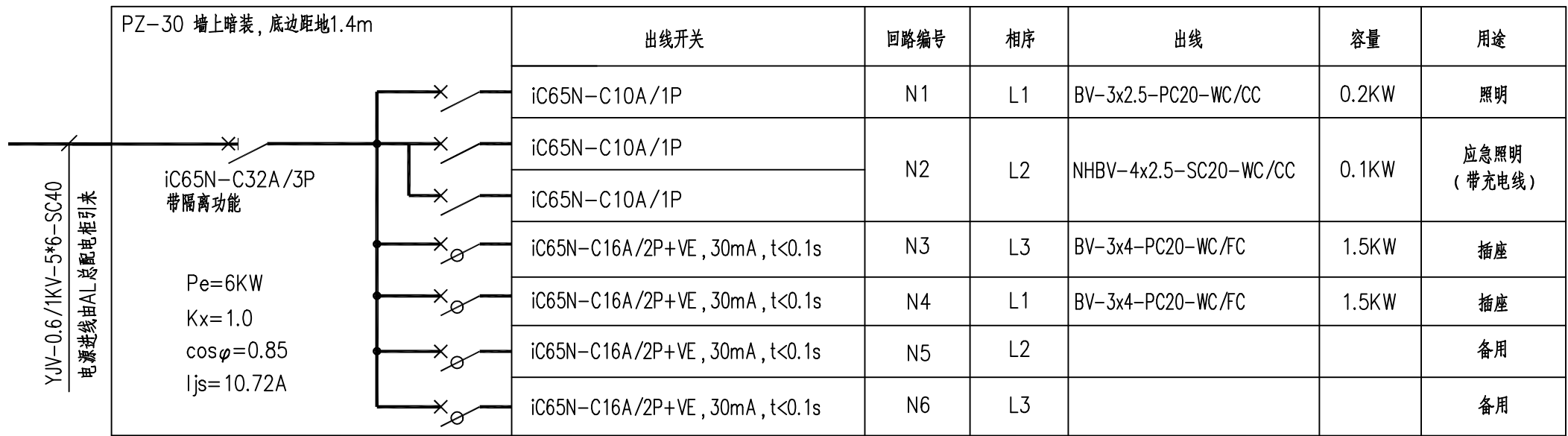
AM照明插座配电箱 配电系统图
