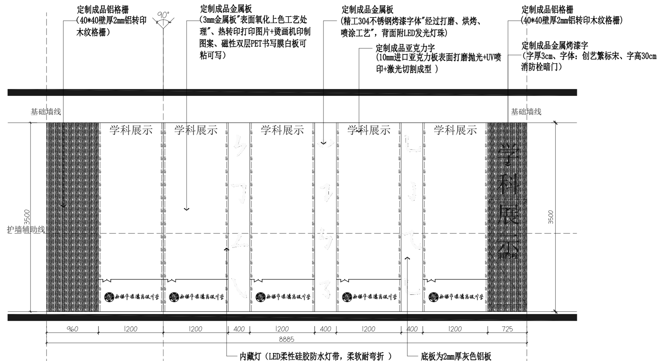
03 ELEVATION 比例 1 : 40 @ A2 5#楼一层西侧墙面造型
