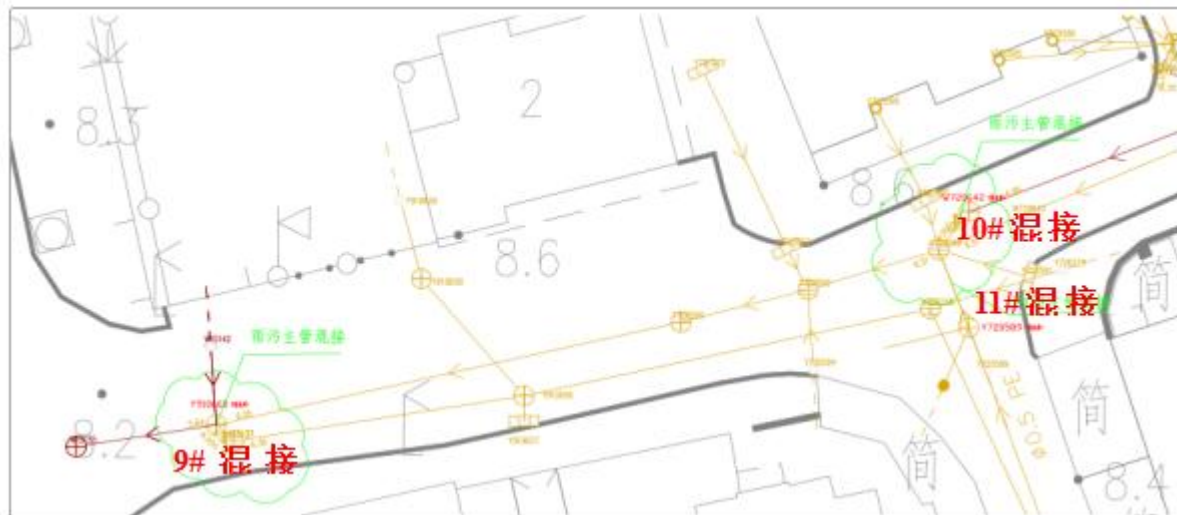
图 3-22 9#、10#和 11#市政混接情况图（永安路）
