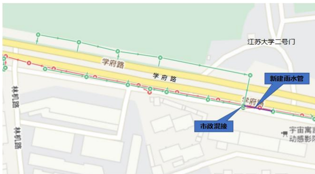
图 5-11 雨水管混接入污水管整改方案图
