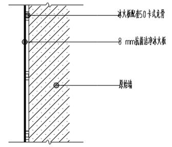
原始建筑墙冰火板安装详图
