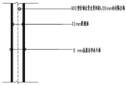
轻钢龙骨隔墙冰火板安装详图
