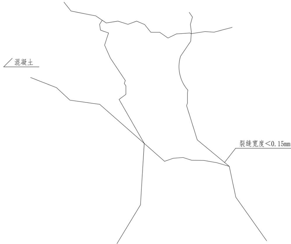
裂缝封闭示意图
