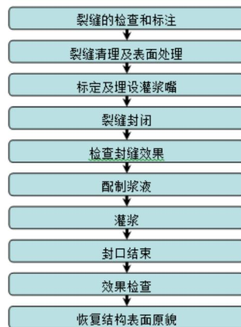
图 4.1-1 灌浆法施工工艺流程图
