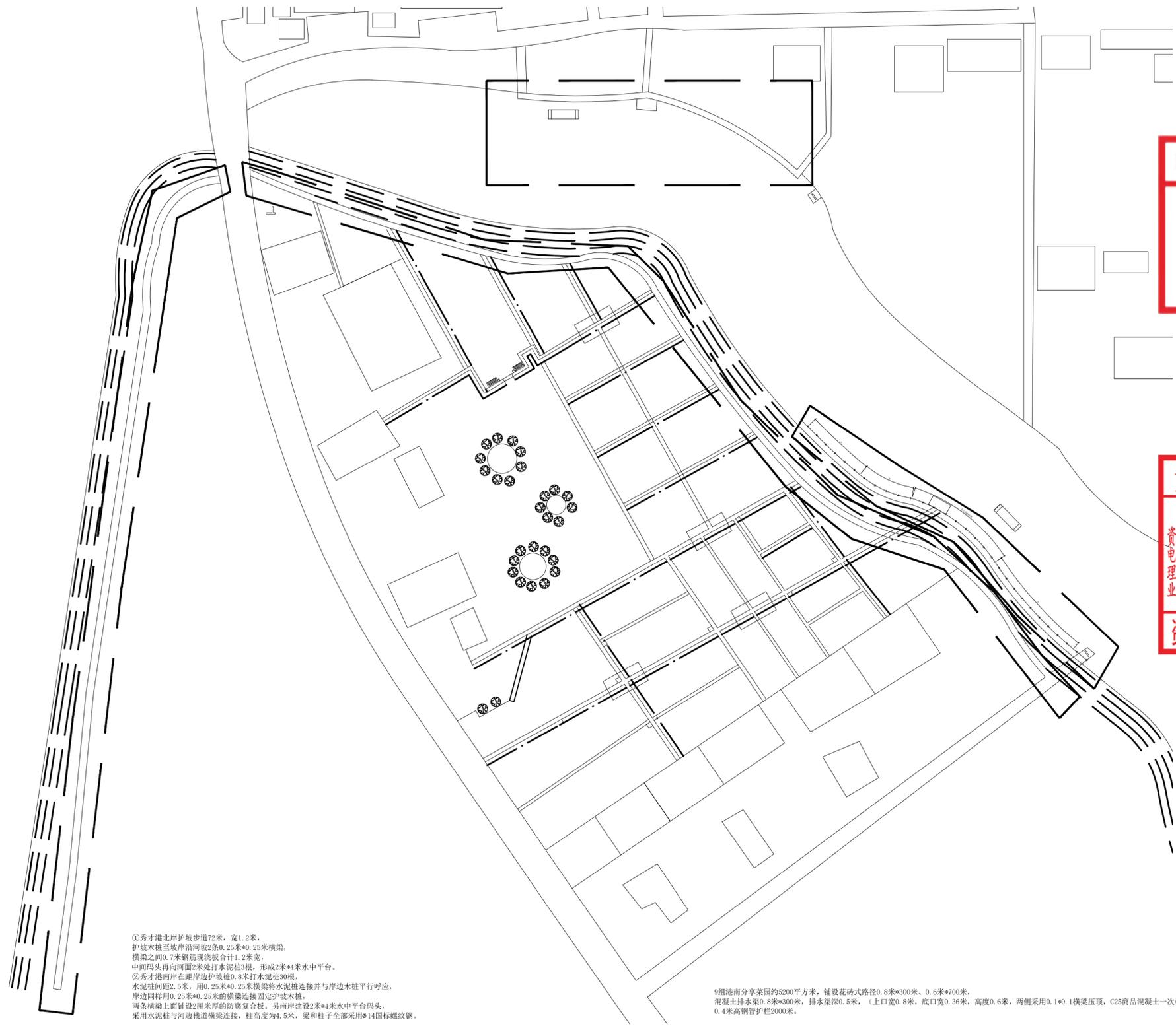
①秀才港北岸护坡步道72米，宽1.2米，护坡木桩至坡岸沿河坡2米\*0.25米\*0.25米横梁，横梁之间0.7米钢筋洗板合计1.2米宽，中间码头再向河面2米处打水泥桩3根，形成2米\*4米水中平台。
