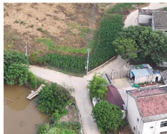
图 4-61 缺少道口警示桩、停车让行标志牌
