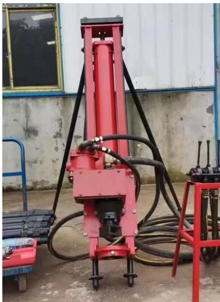
挖巢设备是针对土栖白蚁主巢隐蔽、药剂难以彻底灭杀蚁后的核心痛点设计的专业设备，核心作用是通过“物理挖掘”精准找到并清除白蚁主巢，从根源上断绝白蚁繁殖与扩散，尤其适用于深层地下巢穴、大型群体巢穴、药剂难以渗透的复杂巢穴场景，是“根治型防治”的关键工具。
