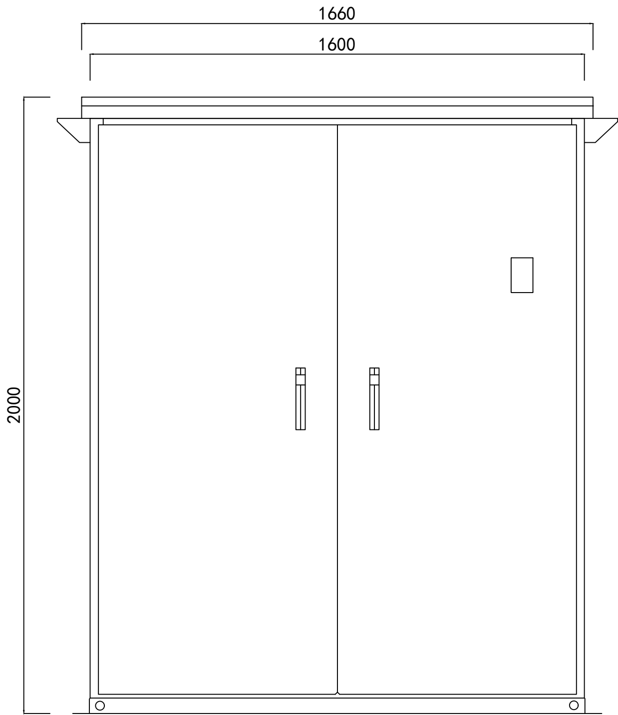
水质自动监测装置正立面图
