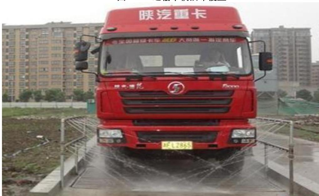
图 7.2-2 运输车辆高压冲洗
