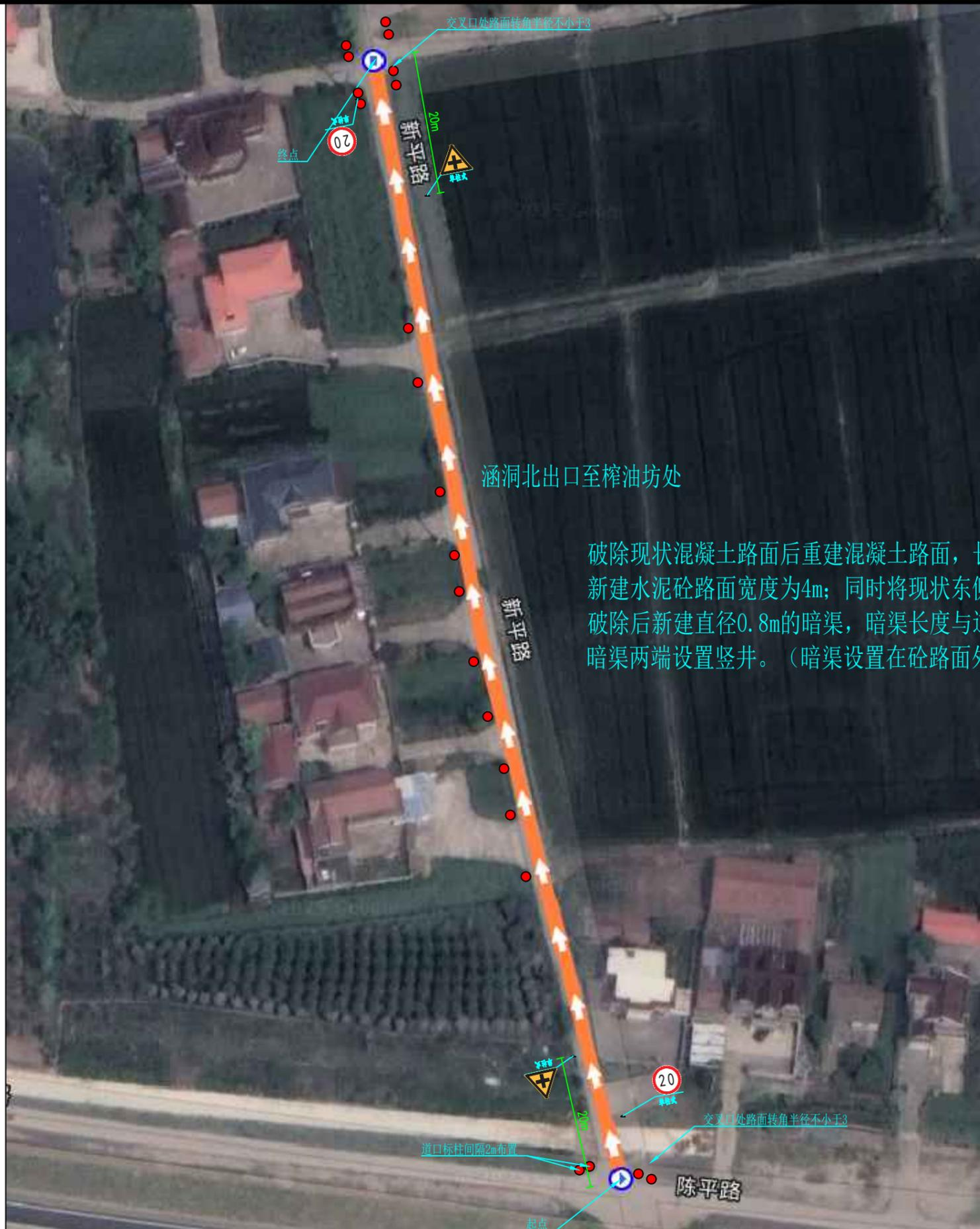
破除现状混凝土路面后重建混凝土路面，长度约205m，新建水泥砼路面宽度为4m；同时将现状东侧硬质沟渠破除后新建直径0.8m的暗渠，暗渠长度与道路一致，暗渠两端设置竖井。（暗渠设置在砼路面外侧）
